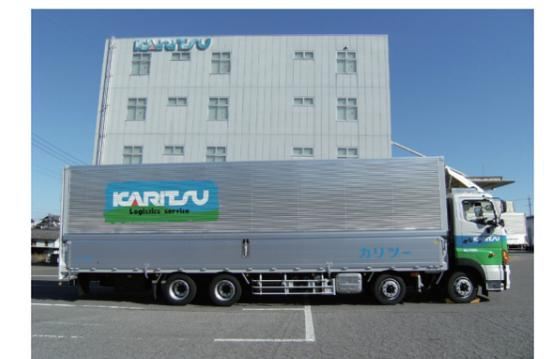
電動開閉式アルミウイング車両
