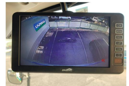
車両室内バックカメラの映像
