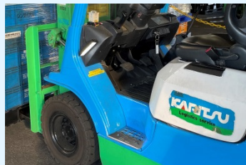
フォークリフトの足元照明
